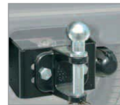
▼ Attelage : boule diamètre 50mm et axe 25 mm. Prise éclairage remorque
